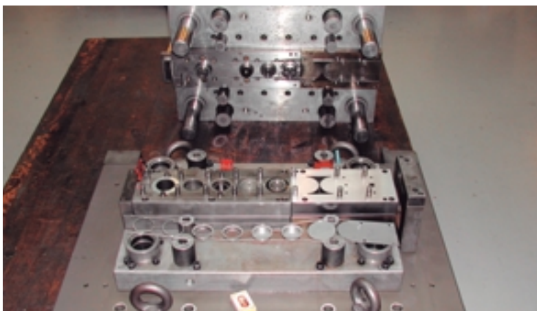
Udvikling af materialevalg gribes særdeles seriøst an hos Grundfos. Her ses et værktøj, hvor matricen i første træk er reference ved endelig bedømmelse af nyt materialevalg. Værktøjet producerer ca. 8 mio. emner per år.
